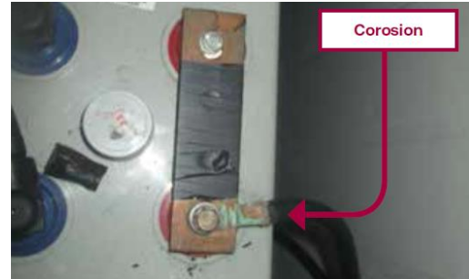
टर्मिनलमा खिया लागेको जसले गर्दा ब्याट्रीको इन्टर्नल रेजिस्टेन्स (Internal resistance) बढाउँछ ।
